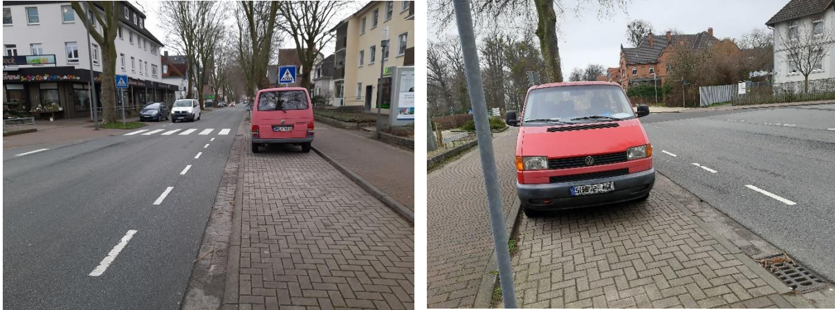
Abbildung 14: Schlechte Sichtbeziehungen am Fußgängerüberweg in der Rodenberger Allee. Aus Fahrbahnsicht (links) und Fußgänger -Sicht (rechts).
